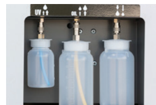
1 db frissolaj-tartállyal – 1 db használtolaj-tartállyal – 1 db UV-adalék-tartállyal felszerelve
